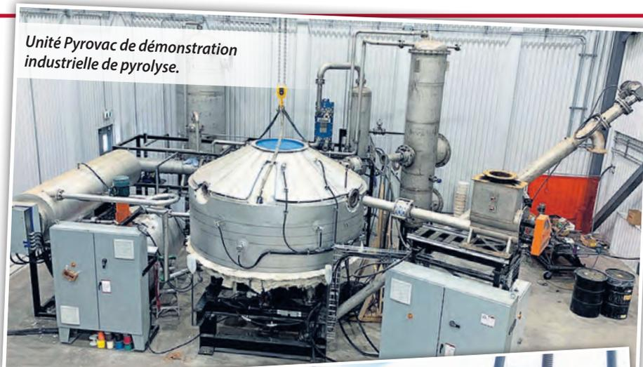
Unité Pyrovac de démonstration industrielle de pyrolyse.
